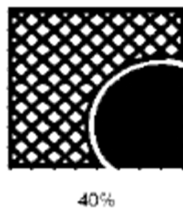
图 2.PCB 铺铜推荐效果
